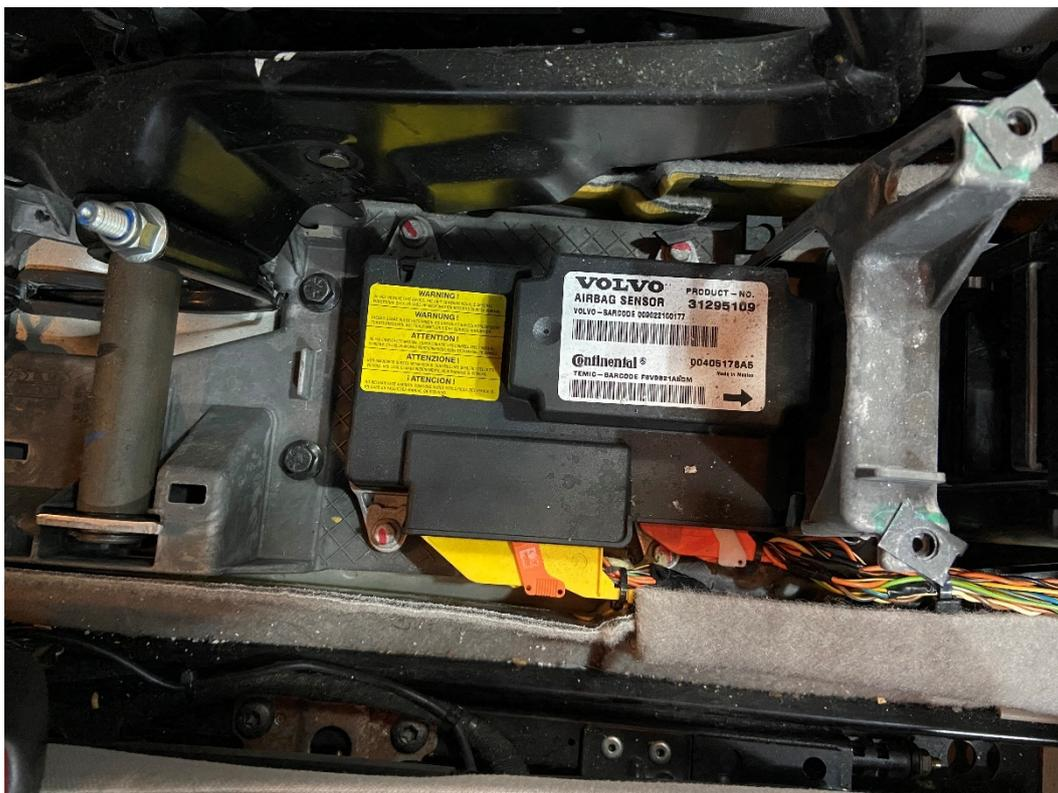
汽车安全气囊电脑是气囊系统的控制中心，缩写称为 SRS-ECU，其作用是接收碰撞传感器及其它各传感器输入的信号，判断是否点火引爆气囊充气，并对系统故障进行自诊断。
